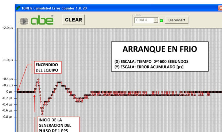
Fig. 4 Gráfico de rendimiento de GPS1000 en tiempo y frecuencia de referencia certificado por el Instituto Galileo Ferraris
